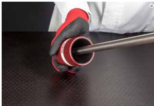
Sbavatura del tubo / Deburring the pipe / Entgraten des Leitungsrohres / Ebavurage des tubes / Quitar la rebaba
