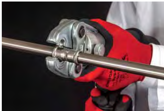
Assemblaggio attraverso pressatura / Making the press connection / Herstellen der Pressverbindung / Réalisation du sertissage / Realizar la conexión de prensar
