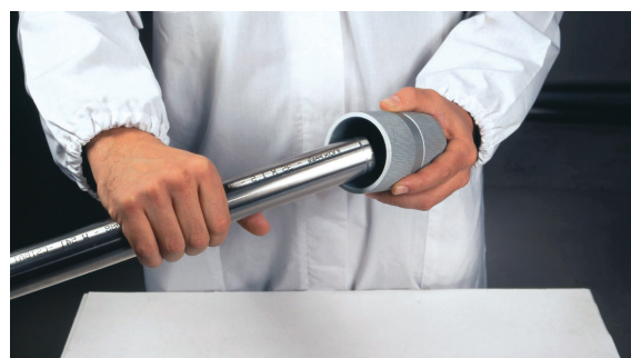
Kuva 16 - Putken purseiden poisto
