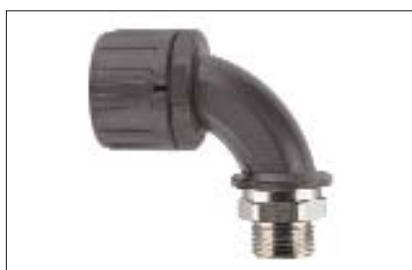
HelaGuard HG-90M 90°-kulmaliitin, pyörivä messinkinen ulkokierre.
