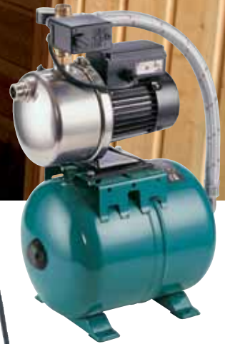
Tankillinen (24 l) JP5-T ja JP6-T • varustettu kalvopaine- säiliöllä, painekatkaisija- lla ja painemittarilla
