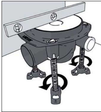
Kuva 93. Vieser One -lattiakaivon tukeminen betonivalun yhteydessä.
